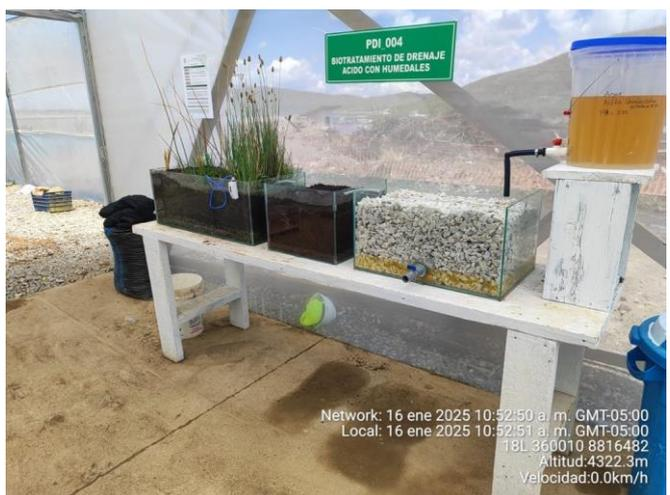
**Figura 15.** Armado de pozas del segundo piloto de biotratamiento de DAM.
