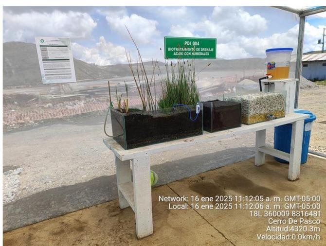
**Figura 14.** Inicio de pruebas del Sistema piloto de Biotratamiento.
